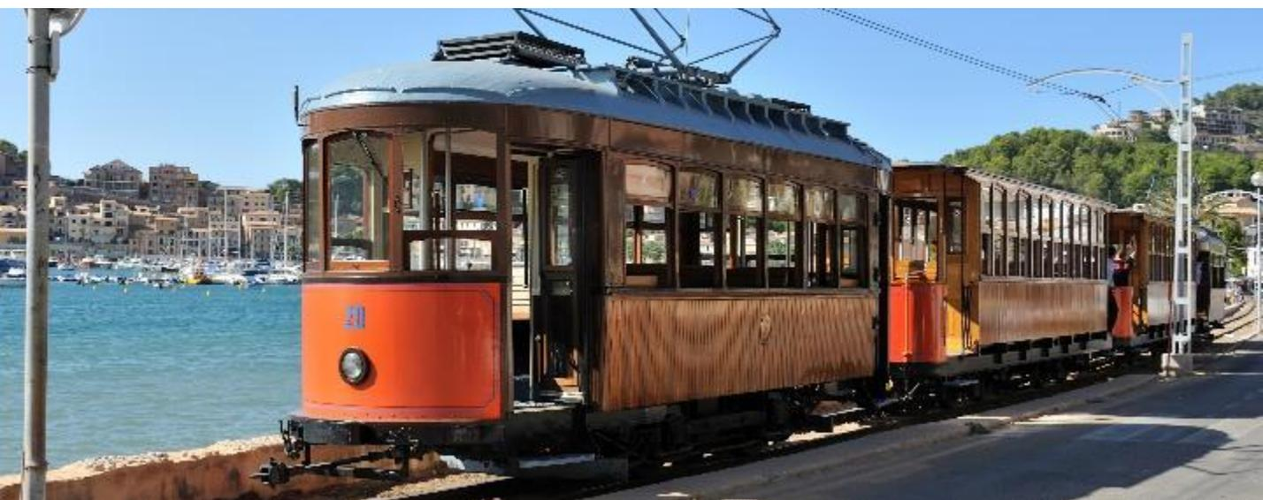
**A FERROVIA DE SÓLLER** caracteriza-se, entre outras coisas, por ser uma estrada de ferro de trilho estreito, com uma largura de 914 mm (jarda inglesa) pouco comum atualmente e por apresentar um material móvel antigo muito variado, bem detalhista e de manutenção artesanal.
